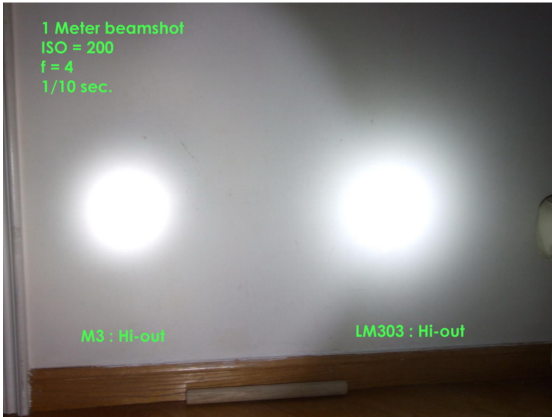
Left : M3 High (123A, 3V), Right : LM303 (RCR123A 4.0V)
